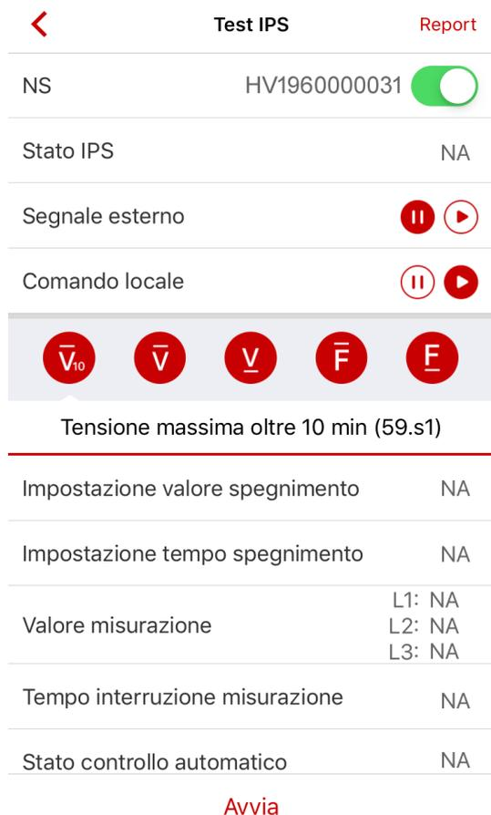
**Passo 2** Scegliere di avviare il controllo S1 o S2 in base alle esigenze. Il tipo di controllo predefinito è S2. Per avviare il controllo S2, è necessario impostare **Segnale Esterno** o **Comando Locale**.
