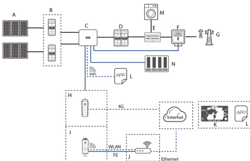
**Figura 2-3** Applicazione per il collegamento in rete - Scenario inverter a cascata (opzionale nelle caselle tratteggiate)
